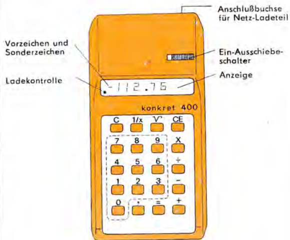
Bild 3.1.: Rechner mit Bedien-Elementen Bedeutung der Bedien-Elemente
